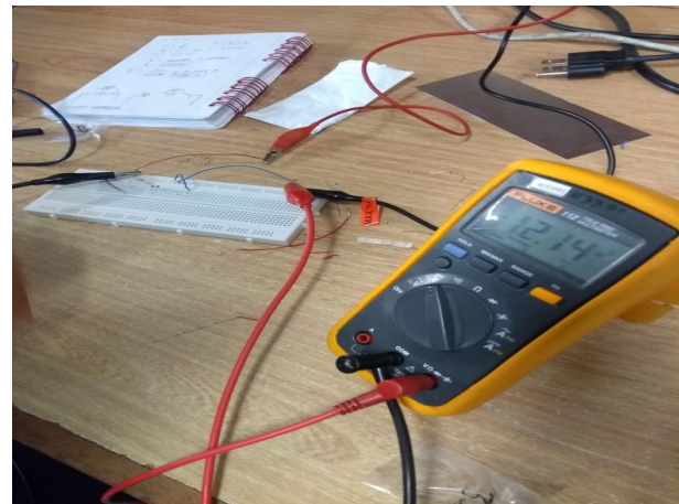
Figura 5. medicion de los voltios con un resistor de 100kΩ .
